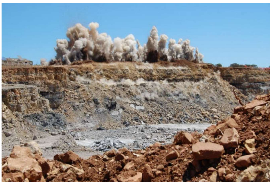
Fig. 5.4/C - Abbattaggio della copertura carbonatica con esplosivo.
