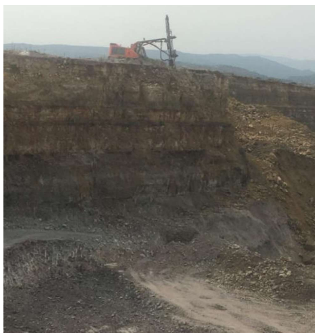
Fig. 5.4/B - Foto del perforatore in azione sul banco carbonatico/dolomitico.
